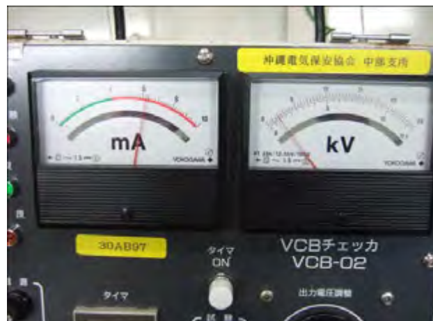
写真2. 真空度試験結果
