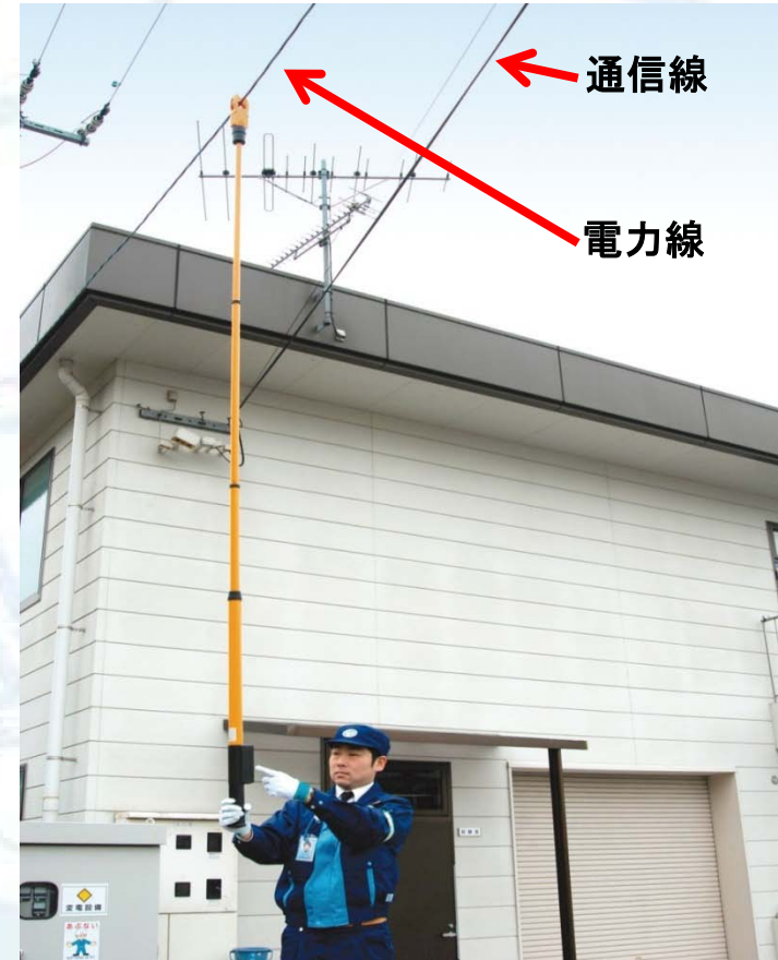
漏洩電流測定
