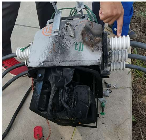
【落雷による被害を受けた開閉器】
